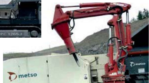
Стрелы-манипуляторы установлены на мобильных дробильных комплексах
