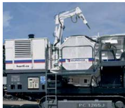
Стрелы-манипуляторы установлены на мобильных дробильных комплексах
